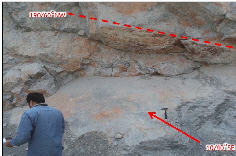
แสดงแนวแตกของหินปูนเนื้อโดโลไมต์ บริเวณด้านทิศตะวันออกเฉียงเหนือของพื้นที่ประทานบัตร (ถ่ายจากบริเวณพิกัด 560922E/1544818N มองไปทางทิศตะวันตกเฉียงใต้)
