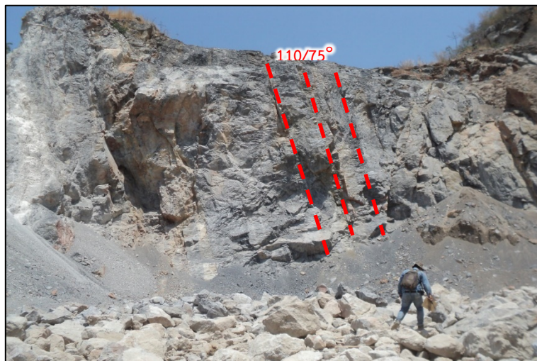
แสดงแนวแตกของหินปูนเนื้อโดโลไมต์ บริเวณด้านทิศเหนือของพื้นที่ประทานบัตร (ถ่ายจากบริเวณพิกัด 553296E/1536753N มองไปทางทิศใต้)
